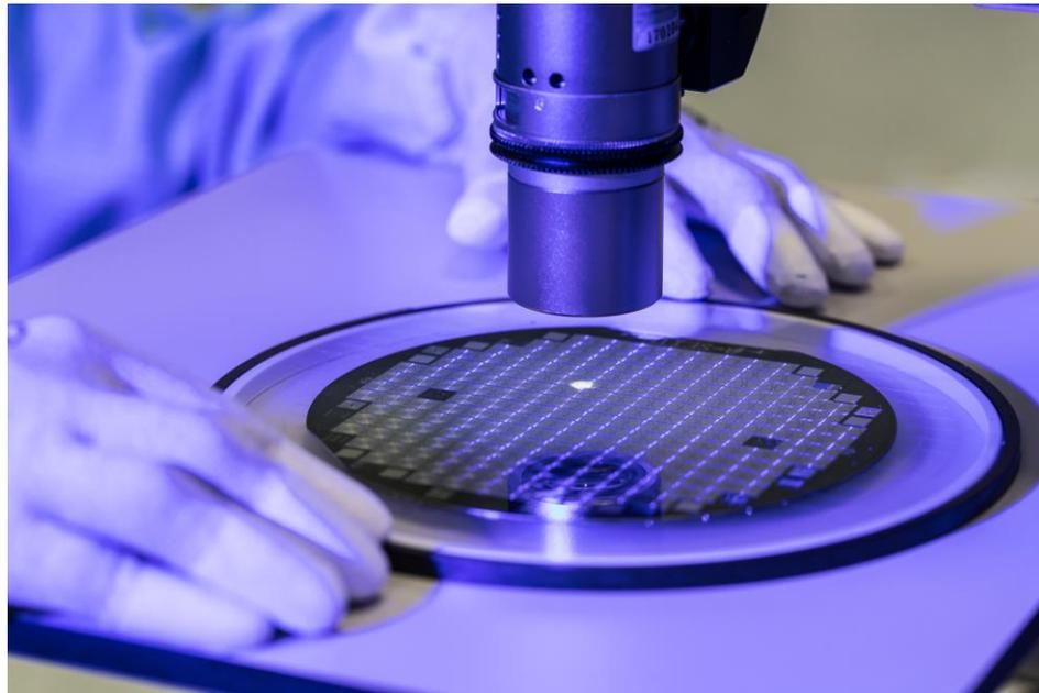
Strukturierter Wafer (Silizium-Scheibe mit Bauelementen)
